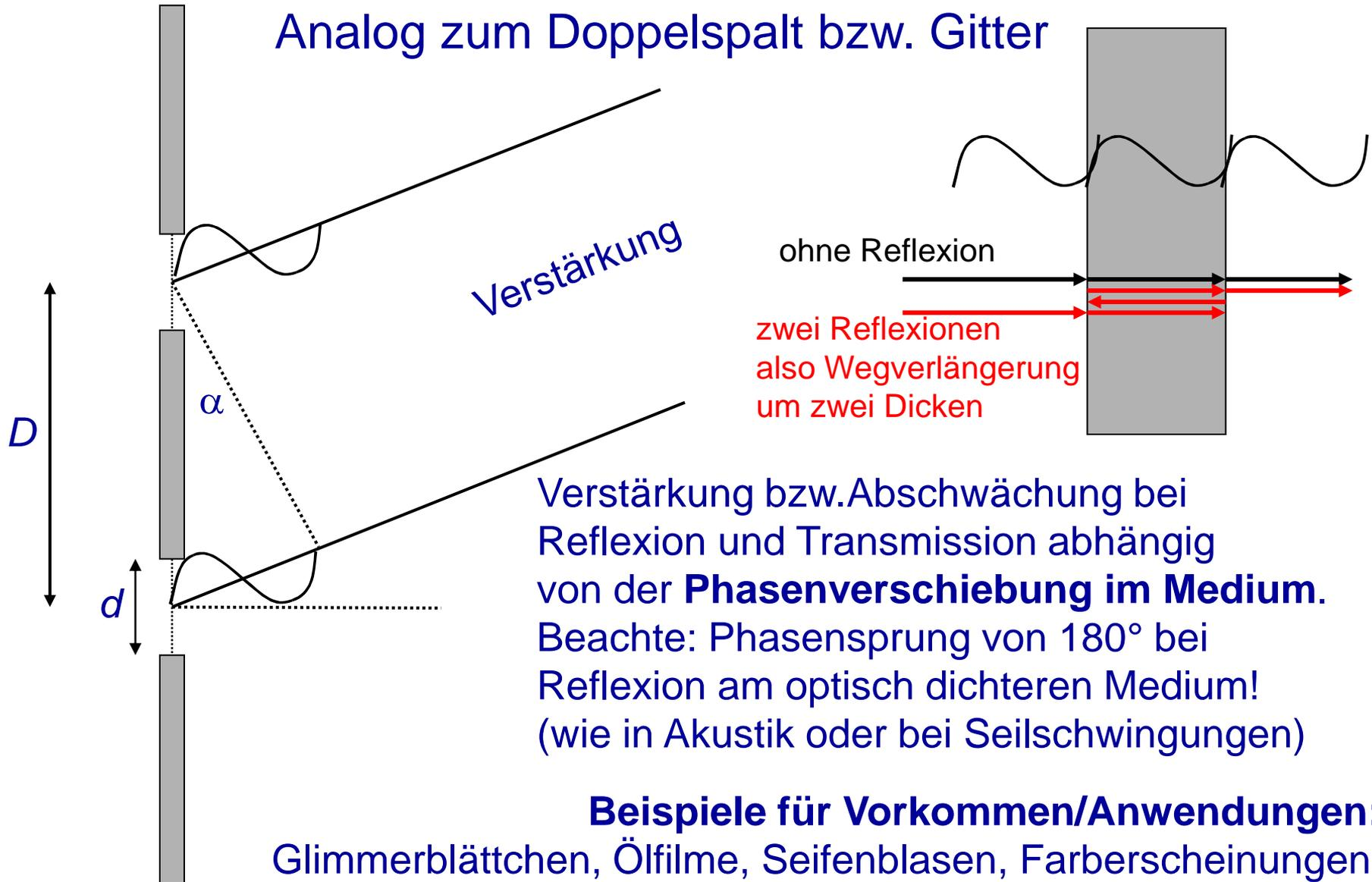
Verstärkung bzw. Abschwächung bei Reflexion und Transmission abhängig von der **Phasenverschiebung im Medium**.
