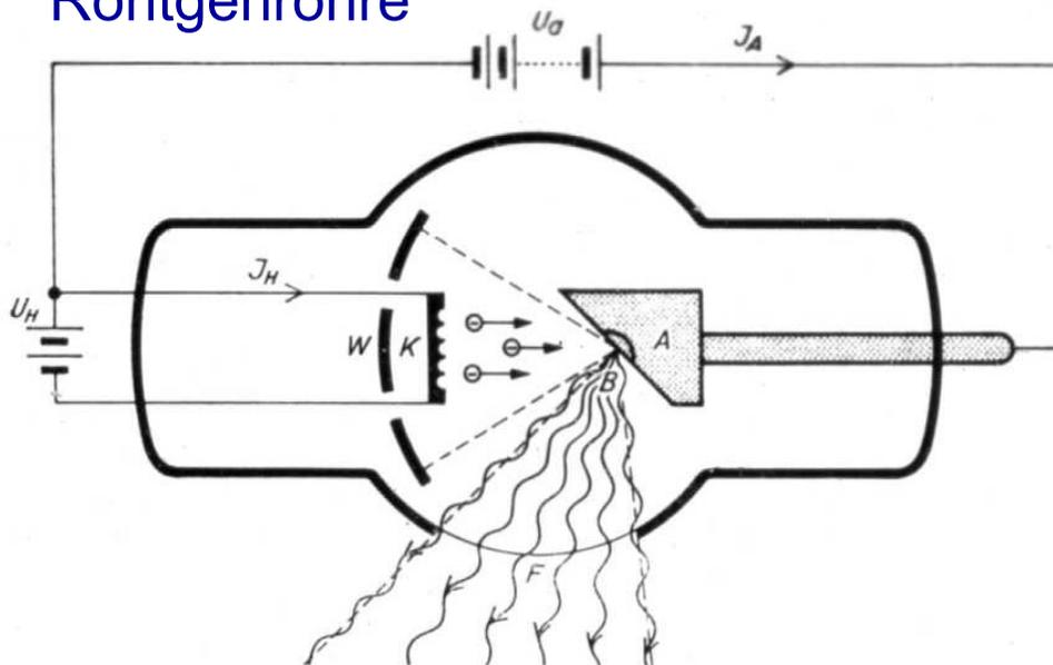
Röntgenröhre (schematisch).  $U_a$  Anodenspannung;  $W$  WEHNELT-Zylinder;  $U_H$  Heizspannung;  $A$  Anode;  $I_A$  Anodenstrom;  $E$  Austrittsfenster (Beryllium);  $K$  Kathode;  $B$  Brënnfleck
