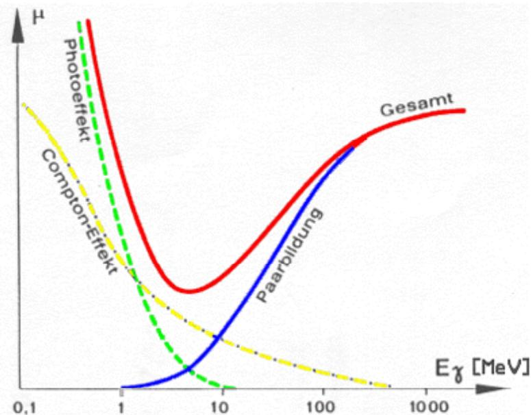
Schematischer Verlauf des Absorptionskoeffizienten als Funktion der Röntgenenergie (bzw.  $\gamma$ -Energie)
