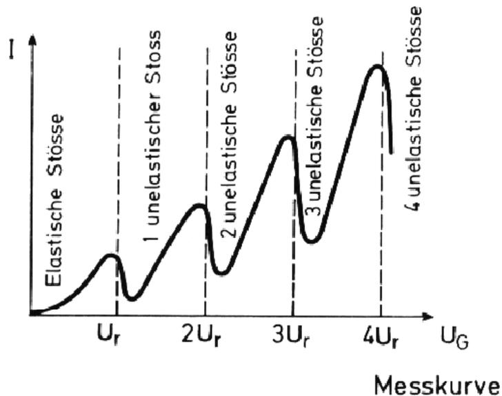
Beschleunigung der Elektronen zw. Heizdraht und Gitter
