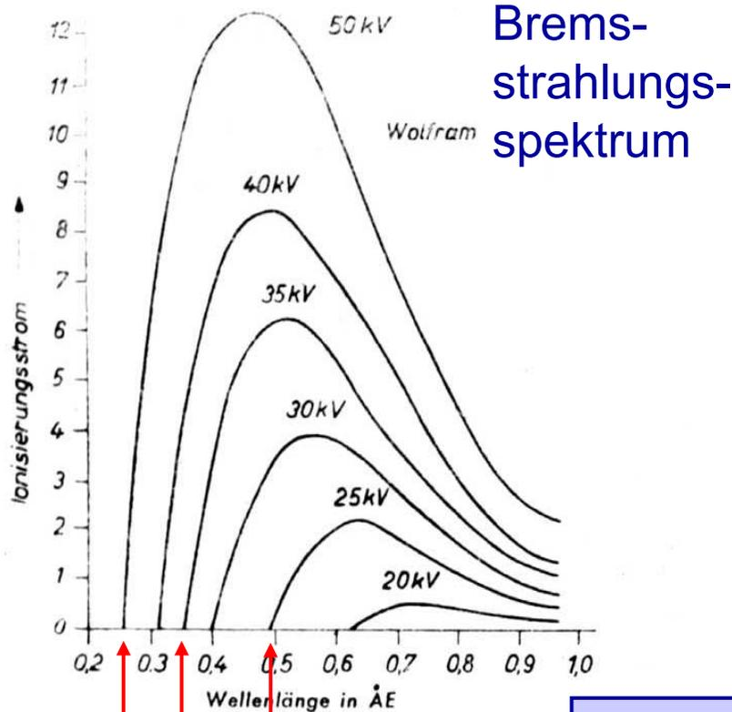
*Spektrale Intensitätsverteilung der Röntgenbremsstrahlung im Bereich*
